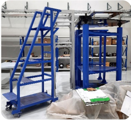
การปรับแก้ไข Support สำหรับติดตั้ง เครื่องฉายรังสีผลไม้
