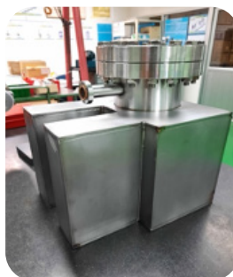
Ultra High Vacuum: UHV ที่ความดันประมาณ 10^{-8} torr - 10^{-11} torr และเป็นปั๊มที่ไม่มีชิ้นส่วนที่เคลื่อนที่จึงไม่มีการสั่นสะเทือน
