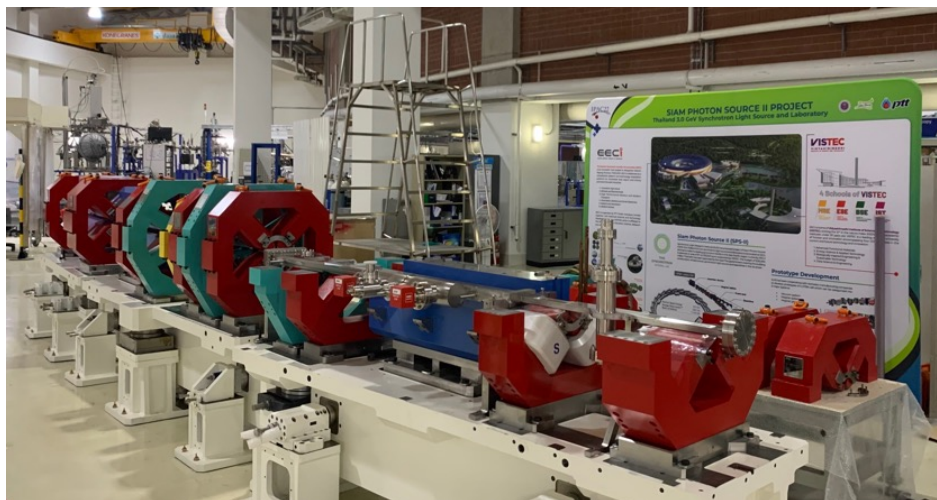
รูปที่ 6 ภาพแสดงการเปิดแม่เหล็กเพื่อติดตั้งท่อสุญญากาศ
